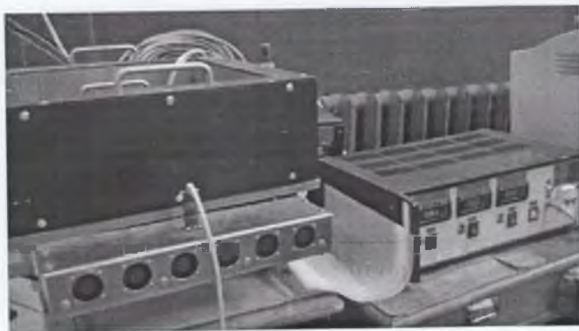
Рисунок 2 – Установки для визначення теплопровідності згідно з ДСТУ Б В.2.7-105 (ГОСТ 7076)
